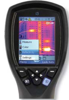
FLIR i3은 3,600 개 지점의 온도를 동시에 측정할 수 있습니다.
